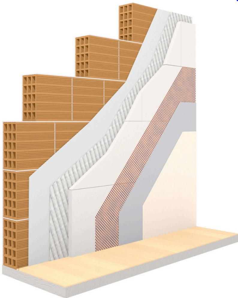
Sistema isolante e deumidificante per l'interno, facile da posare.
